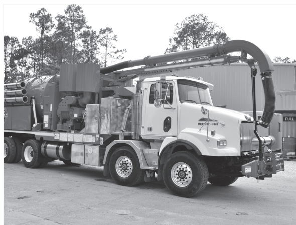
Un camion JetVac typique (Il ne s'agit pas d'un produit StormTech.)
