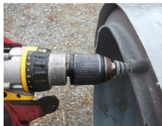
Figure 10: Finition de la soudure
