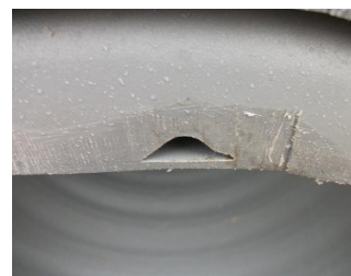
Figure 5: Perçage du tube de ventilation
