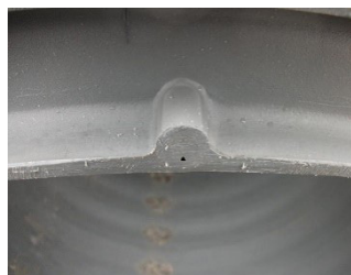
Figure 6: Bouchon de ventilation dans le mandrin
