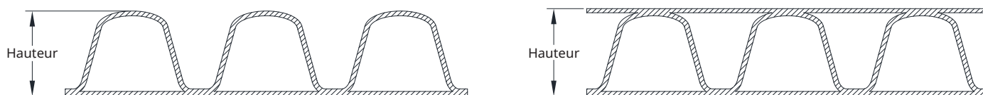
Figure 1: Profils de conduite à double et triple paroi
