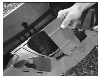
5. Installez la plaque antiéclaboussure. Insérer le tuyau dans l'obturateur d'extrémité, environ 100 mm (4 po). (Les vis sont optionnelles.)
