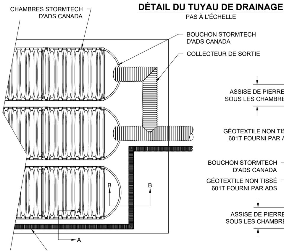
LE DIAMÈTRE DES TUYAUX DE DRAINAGE PERFORÉS ET LEUR QUANTITÉ SONT ÉTABLIS PAR L'INGÉNIEUR QUI CONÇOIT LES PLANS
